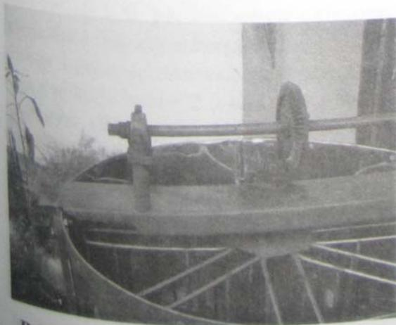
Roda gigi (Gear) Ekstraktor Sentrifugasi
